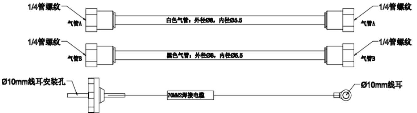
图 2.5.2 X3 用户线定义(焊接用)
